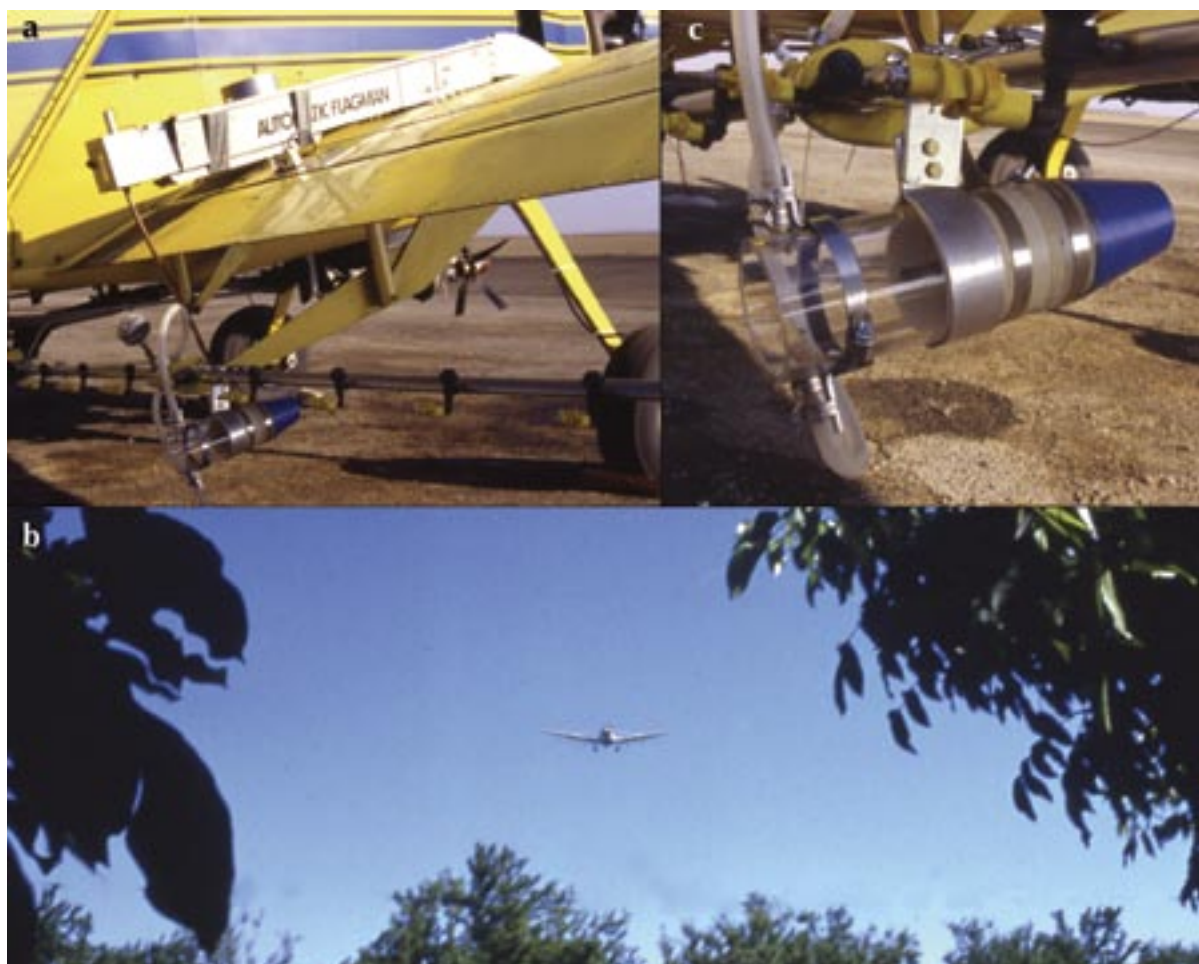
Figuras 26-4a,b,c. Dispositivos en desarrollo para la aplicación aérea de Trichogramma (en huevos parasitados del hospedero) en los huertos: (a) dispositivo de liberación en la ala, (b) la avioneta y (c) acercamiento del dispositivo de liberación. (Fotografías cortesía de Nick Mills.)
